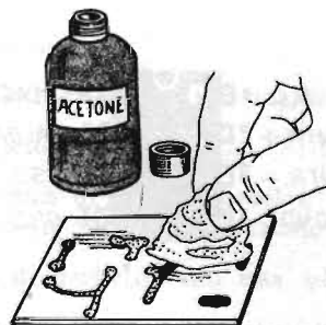
Fig. 6 - La vernice all'acetone si toglie strofinando le piste di rame con un batuffolo di cotone imbevuto di alcool.
