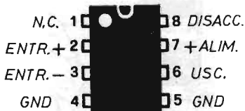
Fig. 8 - L'integrato utilizzato nel montaggio dell'amplificatore audio, descritto nel testo, viene attualmente prodotto in due versioni: una a quattordici piedini ed un'altra a otto piedini, quella disegnata più in basso.
