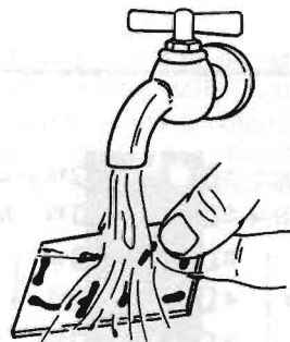
Fig. 5 - La piastrina va tolta dal bagno corrosivo mediante pinze per biancheria e subito posta sotto l'acqua corrente, in modo che ogni traccia di acido scompaia completamente.
