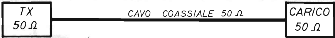
Fig. 1 - Le onde stazionarie sarebbero totalmente assenti, se il carico antenna fosse puramente resistivo e presentasse lo stesso valore ohmmico, come ad esempio quello di 50 ohm citato nel disegno, del cavo coassiale e del circuito d'uscita del trasmettitore.
